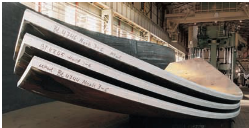
Figura 17 - Conformação de gomos. Fabricante: Dillinger Hutte GTS. (Atente também para a prensa utilizada, ao fundo da figura).
